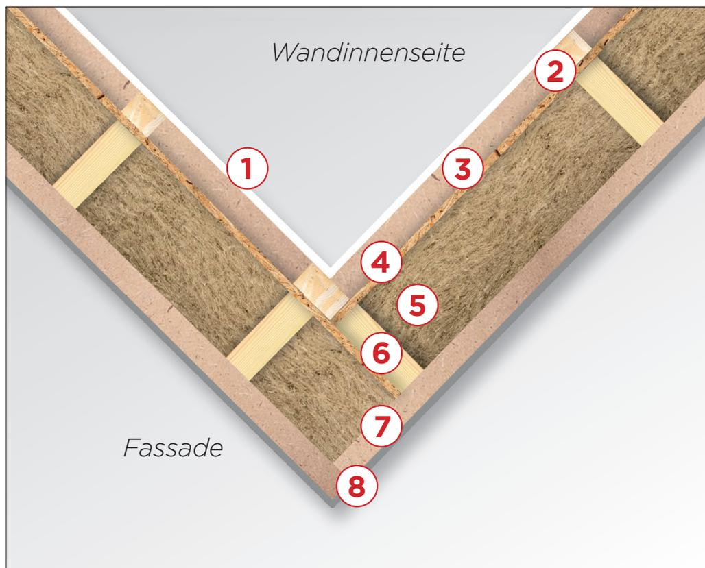
Schematischer Wandaufbau (Eckkonstruktion)
